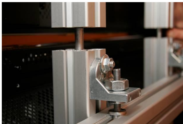
Установка верхней панели
