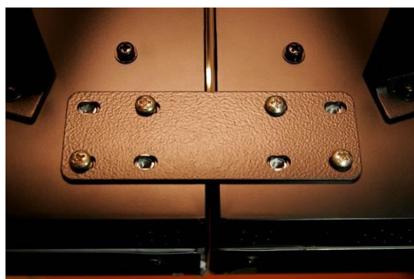
Установка соединительной пластины
