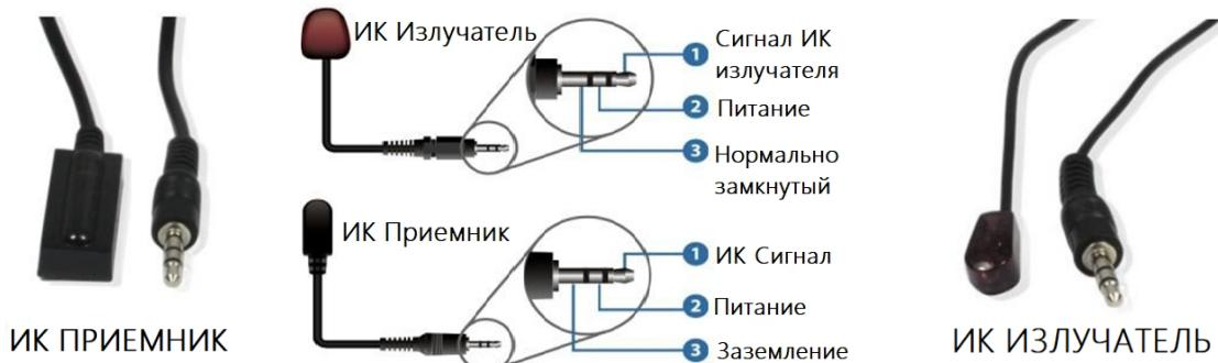
Ниже приведена схема подключения системы передачи ИК-сигналов:
