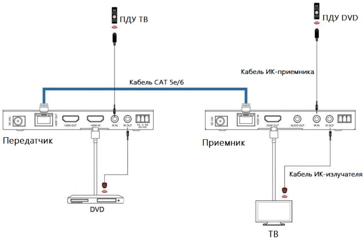
Примечание: когда угол между ИК-приемником и пультом дистанционного управления составляет  $\pm 45^\circ$ , дальность передачи составляет 0-5 метров; когда угол между ИК-приемником и пультом дистанционного управления составляет  $\pm 90^\circ$ , дальность передачи составляет 0-8 метров.
